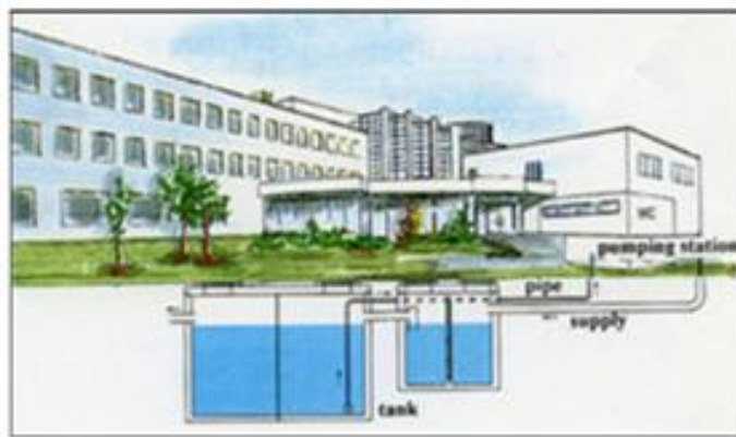
Gambar 2. Skema Sistem Pemanfaatan Air Hujan di Bandara Changi Singapura
