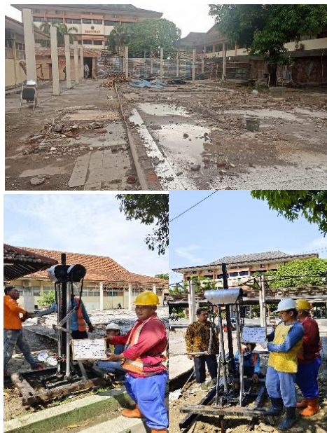
Gambar 1. Lokasi dan investigasi uji tanah metode sondir atau DCPT
