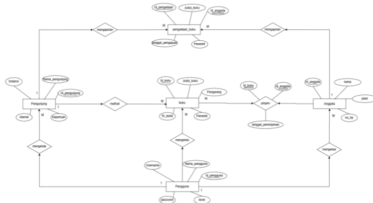
Gambar 11. ERD Sistem Informasi Pengelolaan Pengunjung TBM Al-Azhari
