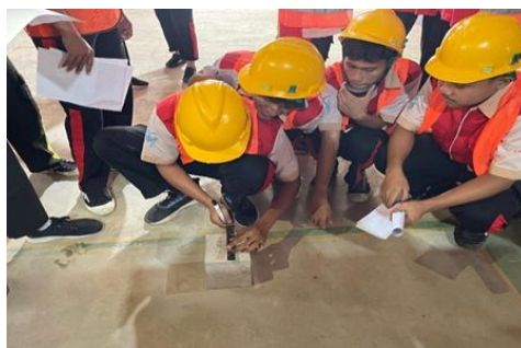
Gambar 3. Praktik pengujian hammer test di lapangan
